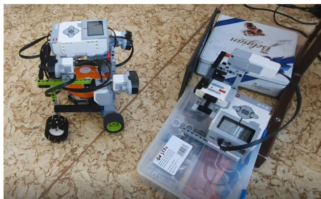
Obrázok 4: Programovateľný vysávač z reálnej robotickej stavebnice LEGO MINDSTORMS
