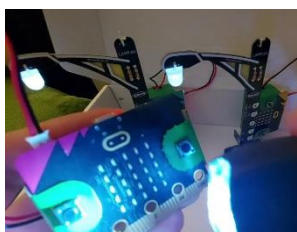
Obrázok 5: Pouličné lampy – rádiová komunikácia
