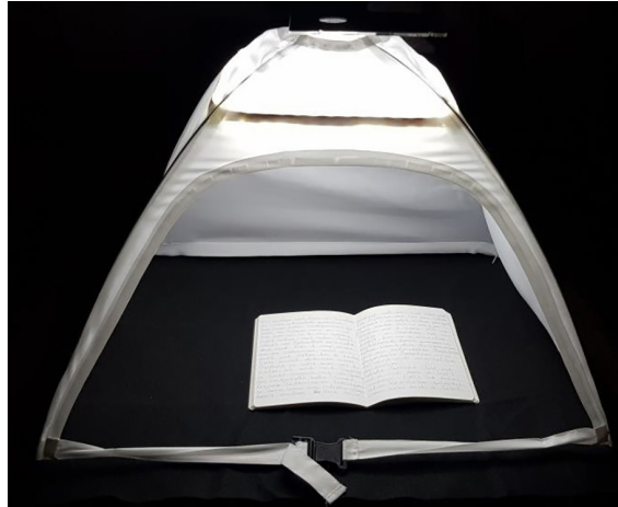
Obrázok 39 ScanTent pripravený na snímanie smartfónom
