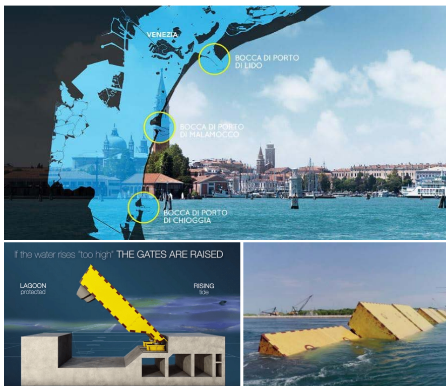
Obr. 13 Schéma proti príливovej brány Mojžiš a umiestnenie zatváracích brán a reálny pohľad na brány
