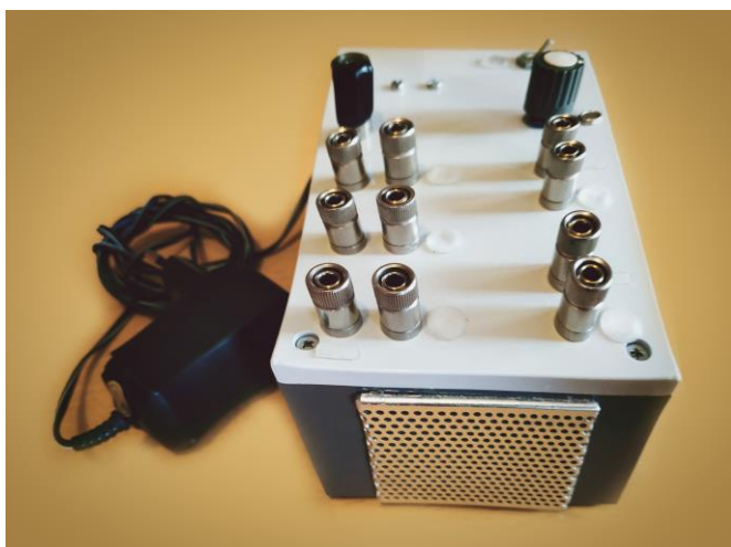
4.5.1-4 Zvukový merací prístroj na odhad odporu, testovanie diód, identifikáciu napätia a sledovanie signálu.
