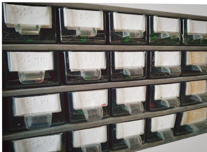
4.5.1-1 Malé zásuvné priehradky s elektrotechnickými komponentami označené Braillovým písmom.
