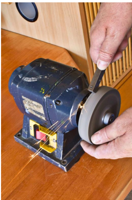
4.6.2.2-4 Vhodná kotúčová brúska má brúsiacu razanciu, ale zároveň pri slabšom dotyku nepoškodzuje pokožku.
