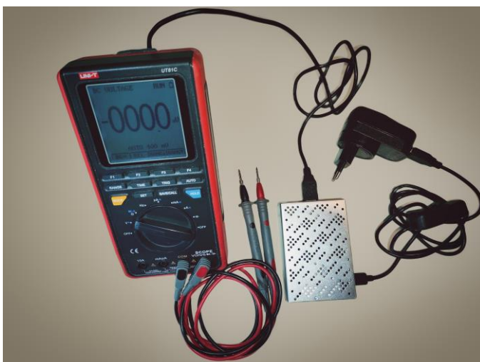
2.3-1 RaspberryPI vybavené rozprávacím softvérom a asistenčnými službami pre multimeter a osciloskop, cez USB je pripojené na kombinovaný multimeter s osciloskopom.
