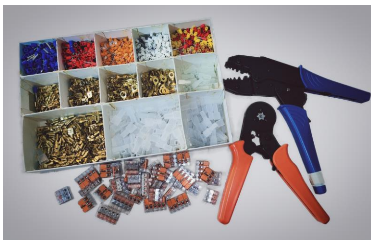
4.5.1-6 Svorky WAGO, FASTON konektory, ukončovacie dutinky a krimpovacie kliešte, ktorými sa Faston konektory a dutinky krimpujú na kábel.
