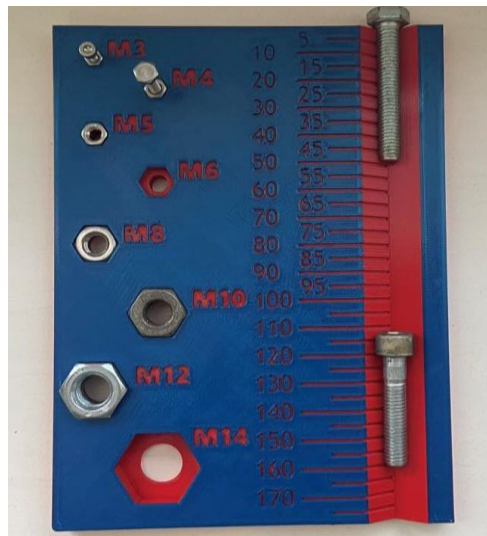
Obr. 1 – Výsledný 3D model na určovanie veľkosti skrutiek a matic
