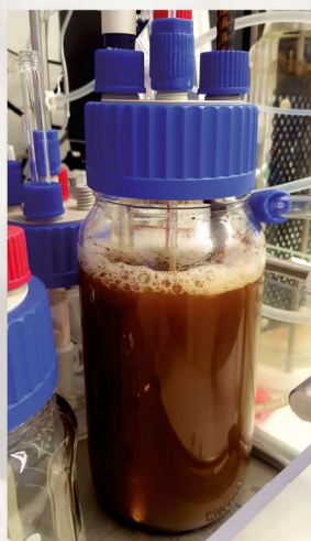
Proces elektrokoagulácie pre odstraňovanie ropných látok zo znečistenej podzemnej vody s použitím Fe elektród (realizácia experimentov – Ústav geotechniky SAV Košice, foto: C. Čičáková)
