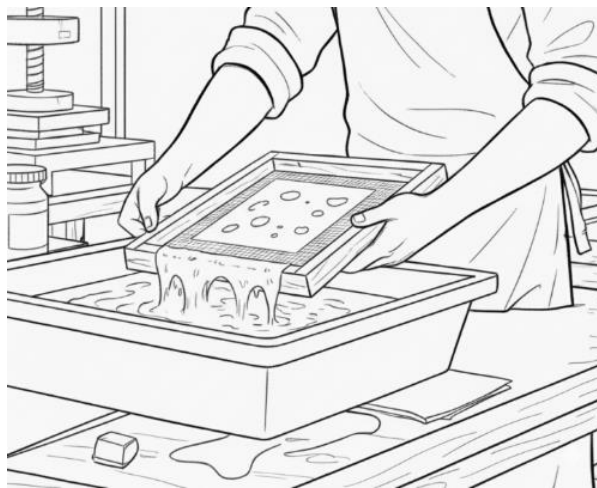
Obr. 54 Výroba ručného papiera , Zdroj: R. Pondelíková
