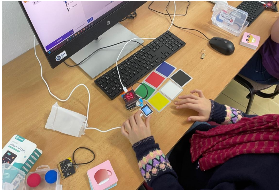
Obr. 4. 9: Edukačná doska micro:bit a rozšírenie Smart AI Lens na workshopoch na základnej škole (Voštinár, 2025)
