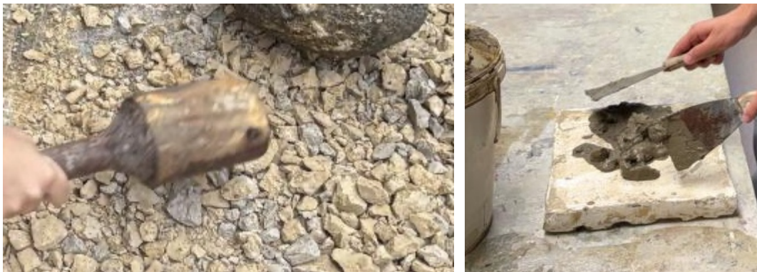
Rozdrvenie a odvodňovanie hliny na sadrovej doske
