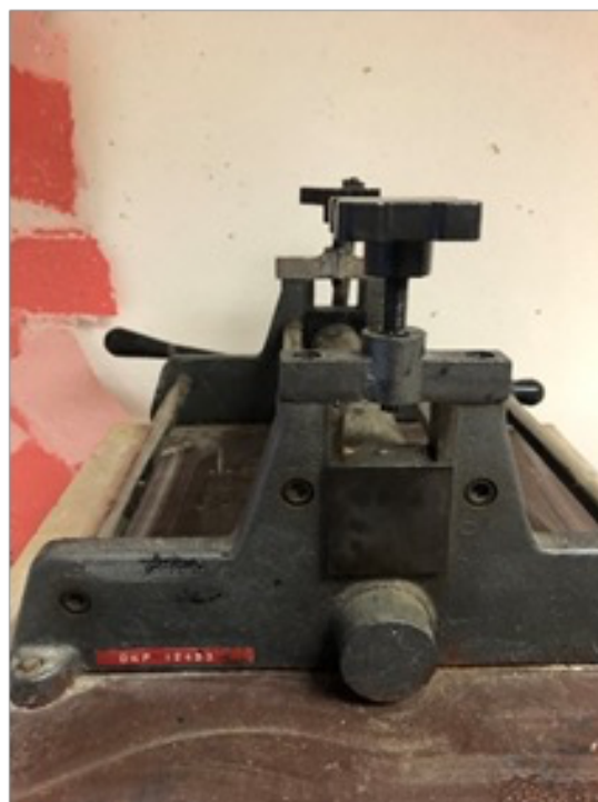
Valkanie plátu ručne s pomocou valčeka a lis
