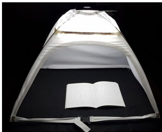
Obrázok 36 ScanTent pripravený na snímanie smartfónom
