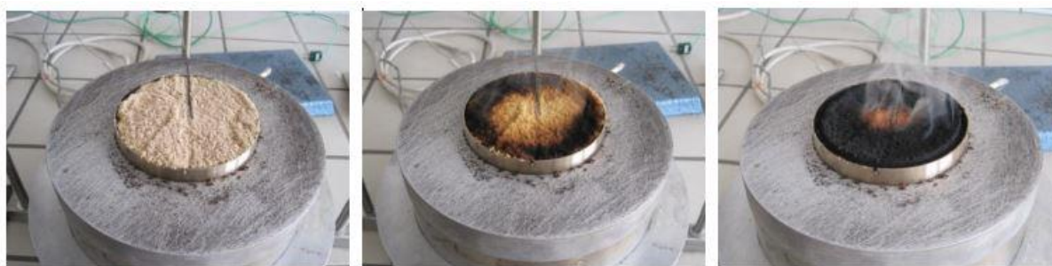
Obr. 22 Ukážka karbonizácie drevného prachu pri experimentálnom stanovení teploty vznietenia podľa STN EN 50281-2-1: 2002 (Pastier et al. 2013)
